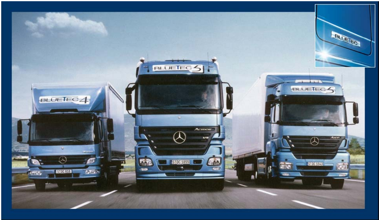
图 16：为达到欧 IV/V 标准而应用 BlueTec® 选择性催化还原技术的梅赛德斯-奔驰中型/重型载重车 (95-440 千瓦)
