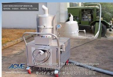
2011年，我公司为南京某部队提供的军用移动式柴油机尾气净化装置。针对仓储移动电源车产生的黑烟进行处理，净化器可有效去除柴油机尾气中95%的碳烟颗粒(PM)，主动再生。
