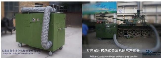
2013年，为6409部队某部门提供的军用移动式柴油机尾气净化装置，针对坦克产生的黑烟及有毒有害气体的处理。
